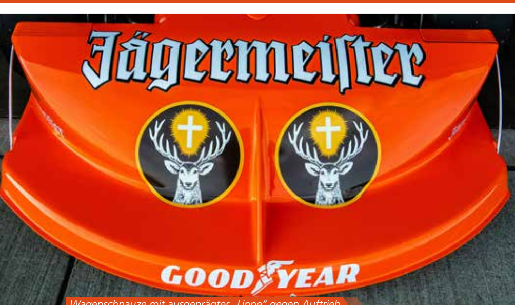
Wagenschnauze mit ausgeprägter „Lippe“ gegen Auftrieb
