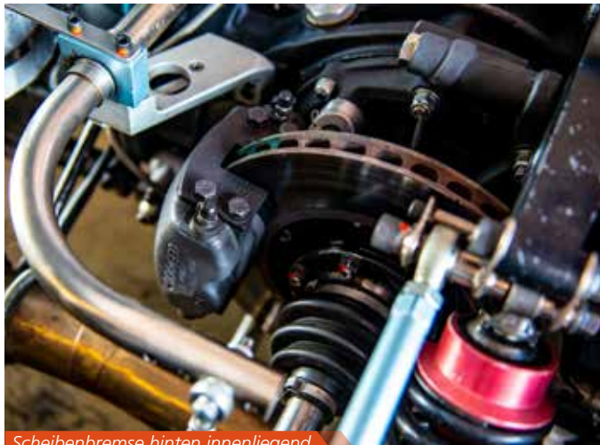
Scheibenbremse hinten innenliegend
