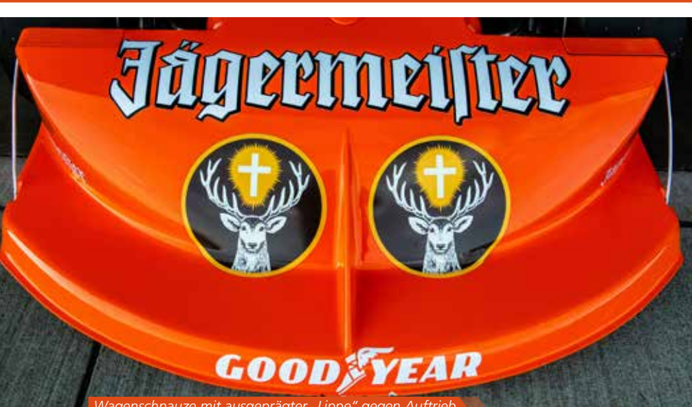
Wagenschnauze mit ausgeprägter „Lippe“ gegen Auftrieb
