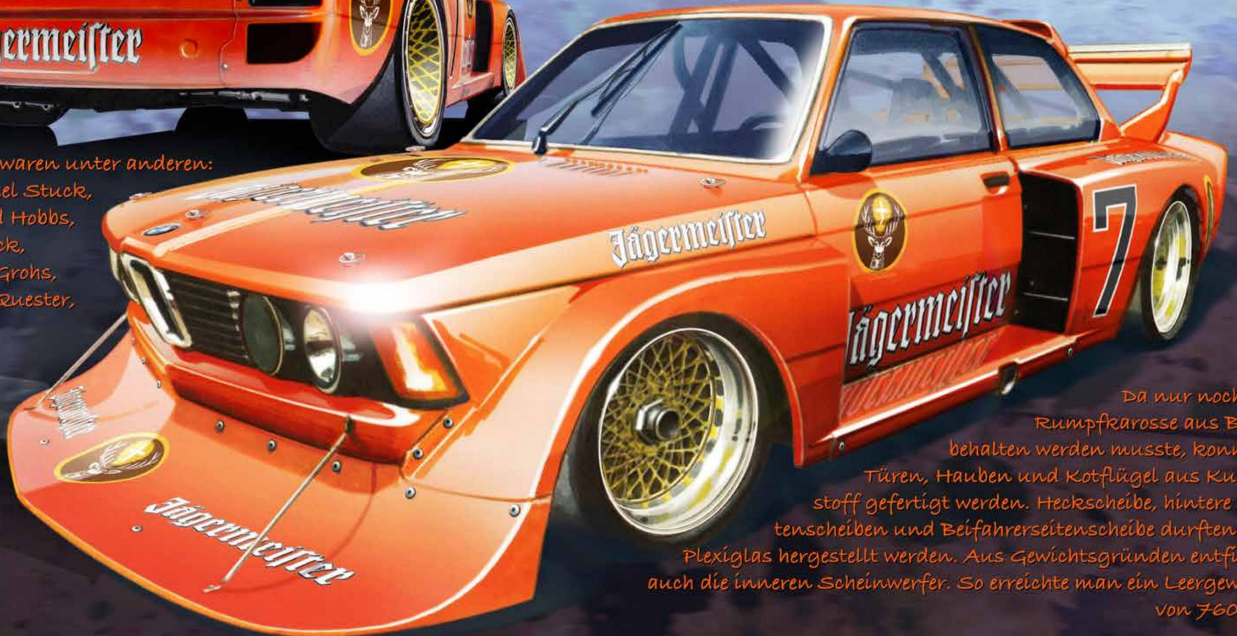
Da nur noch die Rumpfrarosserie aus Blech behalten werden musste, konnten Türen, Hauben und Kotflügel aus Kunststoff gefertigt werden. Heckscheibe, hintere Seitenscheiben und Beifahrerseitenscheibe durften aus Plexiglas hergestellt werden. Aus Gewichtsgründen entfielen auch die inneren Scheinwerfer. So erreichte man ein Leergewicht von 760 kg.
